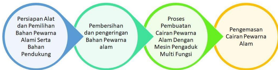
Gambar 5. Teknologi Pembuatan Cairan Pewarna Alami Menggunakan Mesin Pengaduk Multi Fungsi.
