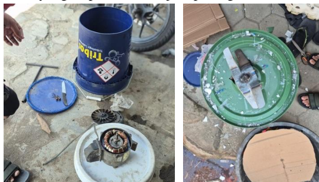
Gambar 3 Membuat TTG Pencacah Sampah
