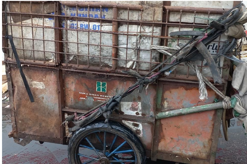
Gambar 9. Bagian luar rangka sudah keropos
